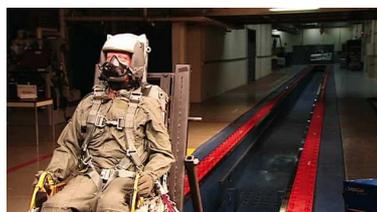
éjectable, mais c'est un mannequin couvert d'appareils de mesure et de capteurs qui y prend place. En quelques fractions de se-
