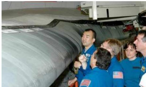
2005 : l'équipage de STS-114 regarde les nouveaux bords d'attaque des ailes en composite carbone équipés de capteurs de choc.
